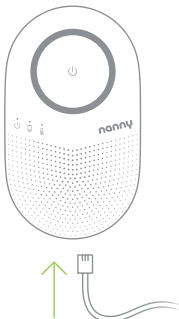
Abb. 9 Anschluss des Verbindungskabels an die Auswerteeinheit
