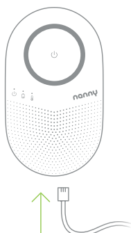
Fig. 9 Connessione del cavo di collegamento all'unità di controllo batterie
