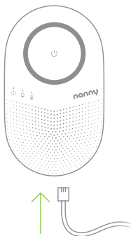
Kuva 9 Liitäntäkaapelin kytkeminen ohjausyksikköön
