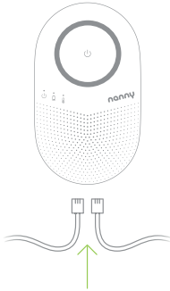
Kuva 14 Kahden anturityynyn liittäminen ohjausyksikköön
