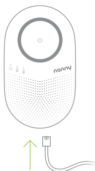
Sl. 9 Povezivanje priključnog kabla s upravljačkom jedinicom
